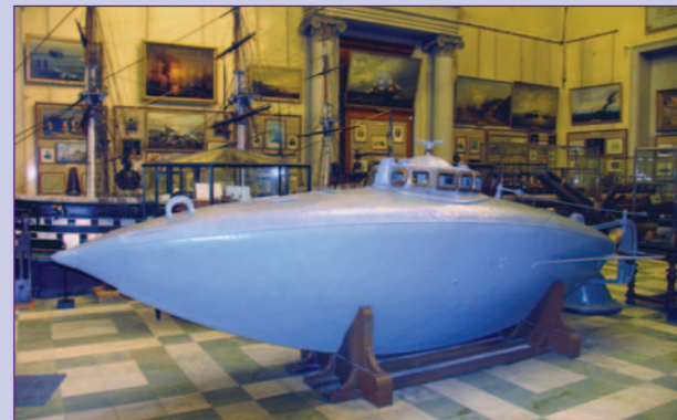
▲ Подводная лодка конструкции С.К. Дджевецкого. Единственный дошедший до наших дней образец серии из 50 единиц 1880-е гг.
